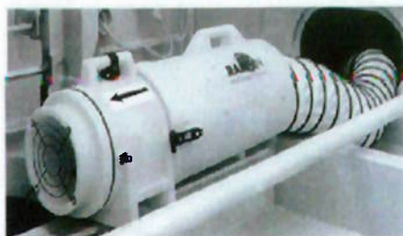
Figura 17 – Exaustor com tubulação
